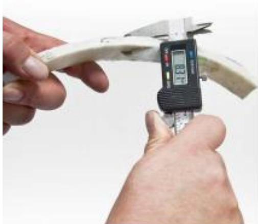
Rys. 2 Pomiar grubości próbki badawczej
